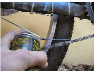
Une huile minérale fluide est suffisante. Pour un usage intensif, utilisez un lubrifiant spécialisé au Téflon, moins collant et moins salissant.
