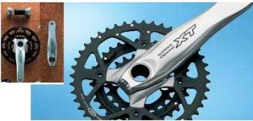
Vérifiez le serrage des manivelles et le jeu de l'axe de pédalier. Saisissez les manivelles et forcez latéralement pour sentir les éventuels desserrages. De la même façon, chaîne enlevée des plateaux, tournez les manivelles. Si vous sentez une résistance ou un jeu, le boîtier doit être démonté.
