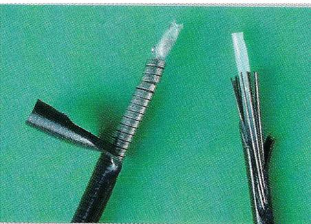
Pour la gaine de dérailleur, ce tube est entouré de brins métalliques, maintenus par une enveloppe extérieure, qui assure la protection contre l'oxydation et pour la gaine des freins, d'un fil plat, enroulé en spirale, maintenu et protégé par l'enveloppe extérieure. Dans les deux cas, la partie métallique assure la souplesse de l'ensemble sans gêner le glissement du câble.
